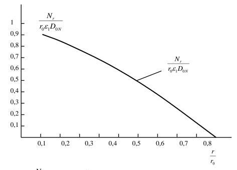
Рисунок 1 – Радиальная сила  $N_r$  подвергающейся температурному нагреву
