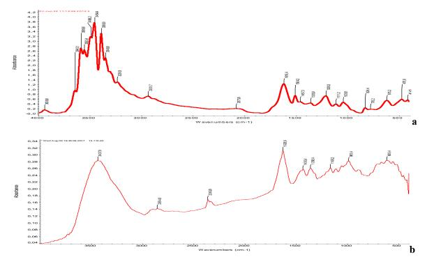
Рисунок 2. ИК-спектр необработанной хлопчатобумажной ткани (а) и обработанной (b)
