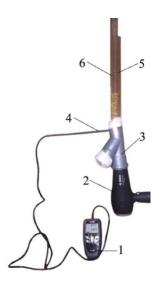
Рисунок 1 - Экспериментальная установка для исследования аэродинамических свойств масличных семян 1 – термоанемометр VT100, 2 – вентилятор (фен), 3 – тройник, 4 – зонд, 5 – линейка, 6 – стеклянная трубка (L=1м)
