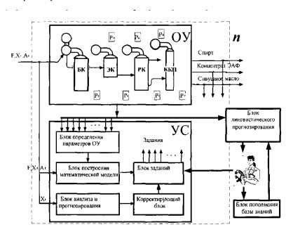
Рисунок 1 – Структурная схема автоматической системы управления процесса ректификации
