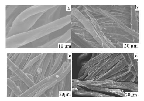
Рисунок 1. Электронно-микроскопические снимки хлопчатобумажной ткани (a) обработанных огнезащитной композицией (b, c, d)
