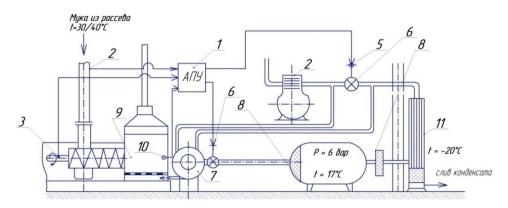
Рис. 1. Предлагаемая схема подготовки аэрозоля муки для пневмотранспортирования: 1-Автоматический пульт управления; 2-Датчик температуры муки; 3- Датчик частоты вращения; 4-Датчик температуры подаваемого воздуха; 5-Механизм управления; 6-задвижка; 7-Управляемая задвижка; 8-фильтр водоотделитель; 9-Камера аэрации; 10-Калорифер; 11-Коденсатор
