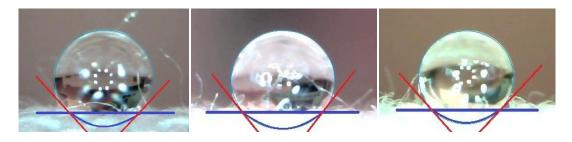
Рисунок 1 — Капля воды на поверхности гидрофобизированной хлопчатобумажной ткани (ПЭГ (20 000) 5 г/л и 2,4—ТДИ 6 мл/л, температура термообратки  $180^{\circ}$  С) с тремя повторениями
