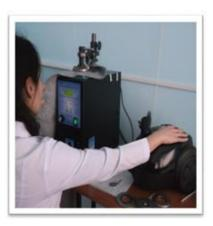
Рисунок 1 - Определение воздухопроницаемости опытных образцов по ГОСТ 12088-77 на приборе МТ-160
