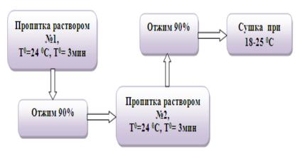
Рисунок – 1 Схема придания огнестойкой отделки безопасным нетканым материалам
