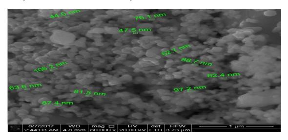
Сурет 1 - Электронды сканерлеуші микроскопия арқылы алынған мыс нанобөлшектері (С<sub>СиSO4</sub>- 0.3 г/л)
