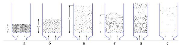
Рисунок 2 - Схемы режимов взаимодействия семян с воздушным потоком
