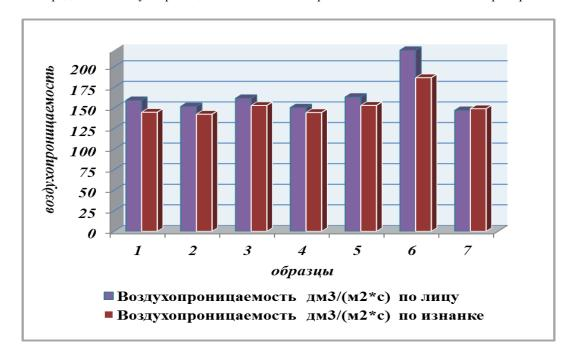
Рисунок 2 - Показатели воздухопроницаемости нетканых образцов
