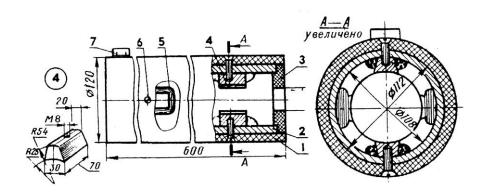
Рис. 2. Схематический разрез устройства для омагничивания молока:
