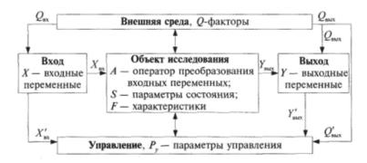
Рис. 3 Факторная модель производственной системы
