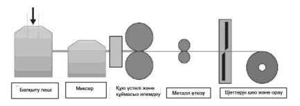
2 сурет - Құймасыз дайындама алудың технологиялық схемасы
